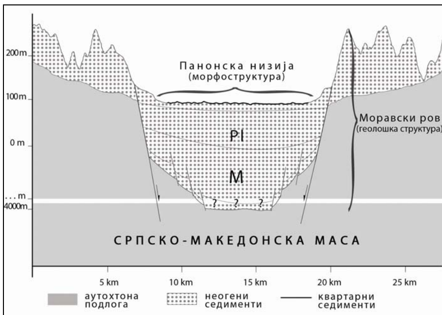
Слика 6. Схематски профил Моравског рова (дебљина седимената према: Курбалија, 1982; цитирано у: Marović et al., 2007)
