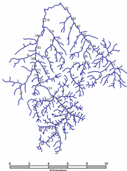
Слика 1 – Увећани сливови Ждраљице и Грошничке реке, по Шревеовј методи, са карте размера 1:25 000
